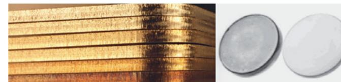
LASERLINE® Stickstoff zum Laserstrahlschneiden zur Spülung des Strahlführungssystems ermöglicht konstante Strahlparameter. Ohne Spülung können Feuchtigkeit, Kohlenwasserstoffe und CO<sub>2</sub> den Laserstrahl verändern und die Optiken beschädigen (siehe oben rechts, verschmutzte/neue Optik).
